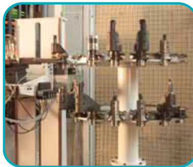
Zusatzmagazine mit bis zu 80 Werkzeugen.
