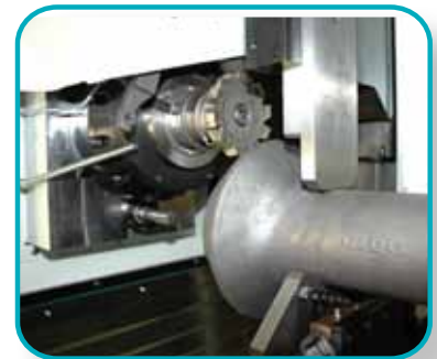
Werkstückspannvorrichtungen, zentrisch arbeitend, wahlweise mit 3-Punkt- oder 4-Punkt-Spannung.
