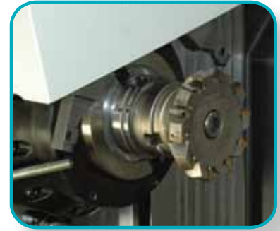
Automatischer Werkzeugwechsler mit Doppelwechslerarm.
