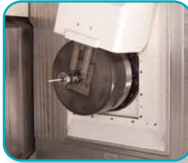
CNC-gesteuerter Plandrehkopf mit elektronischer Wuchteinrichtung.
