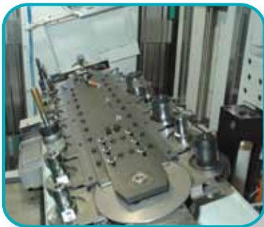
Werkzeugmagazine, ausgelegt als 8-, 16-, 24- oder 32-fach Kettenmagazin.
