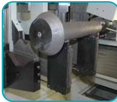
NC-Gesteuerte, höhenverstellbare Werkstückvorauslagen.
