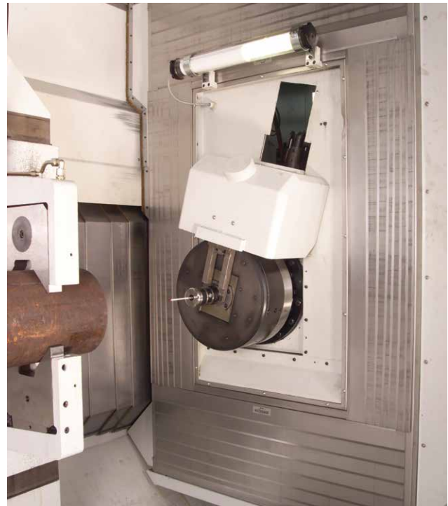
CNC-gesteuerter Plandrehkopf mitelektronischer Wuchteinrichtung
