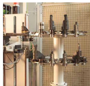
Zusatzmagazine mit bis zu 80 Werkzeugen
