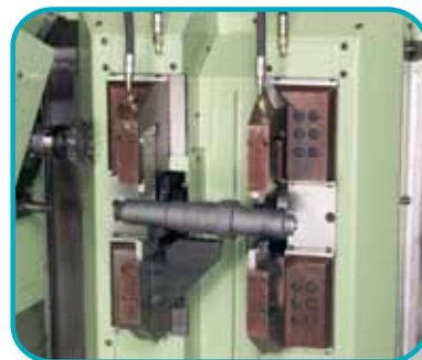
工件夹紧装置，中心工作，可选 3 点或 4 点夹紧。
