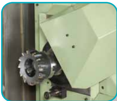
自动换刀器带双换刀臂。
