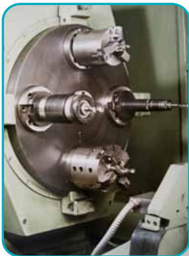
坚固的加工单元带 4 层圆盘换刀器。
