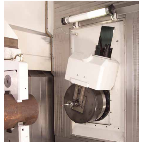
CNC-gesteuerter Plandrehkopf mit elektronischer Wuchteinrichtung
