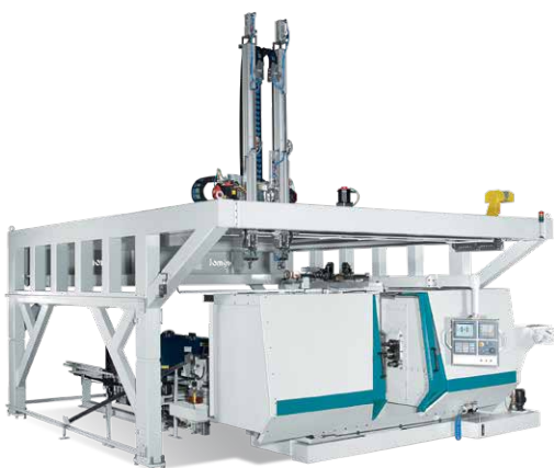
ENDURO V 500 für Bearbeitungsdurchmesser von 10–150 mm und Werkstücklängen von 80–12.000 mm.
