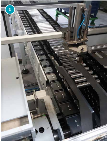
1) ZUFÜHR-FÖRDERBAND mit Aushebung und Wellenprüfung auf Durchmesser und Länge
