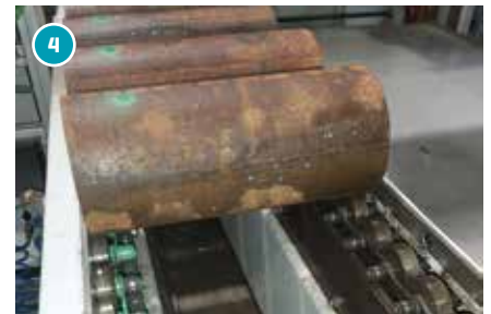
3) FÖRDERBAND mit Kassettenförderkette für variable Durchmesser und Längen
