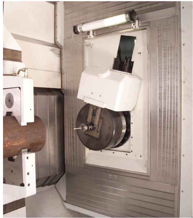
CNC-gesteuerter Plandrehkopf mitelektronischer Wuchteinrichtung
