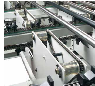
Kettentaktband mit Längs- rollenbahn zum linksbündigen Anschlagen der Werkstücke für die Bearbeitung der ersten Seite, sowie zum rechtsbündigen Anschlagen der Werkstücke für die Bearbeitung der zweiten Seite.
