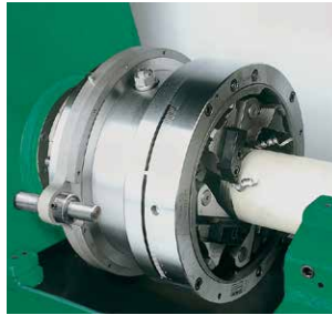
Zum Gewindescheiden und Gewinderollen: Längsschlitteneinheit zum Einsatz von Gewindeschneid-, bzw. Gewinderollköpfen
