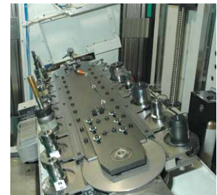
Werkzeugmagazine, ausgelegt als 8-, 16-, 24- oder 32-fach Kettenmagazin
