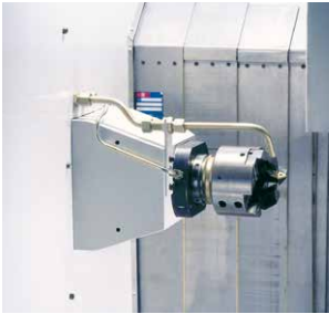
Zum Anplanen und Fasen: Längsschlitteneinheit mit Kombiwerkzeugskopf
