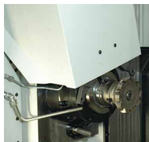
Automatischer Werkzeugwechsler mit Doppelwechsellarm
