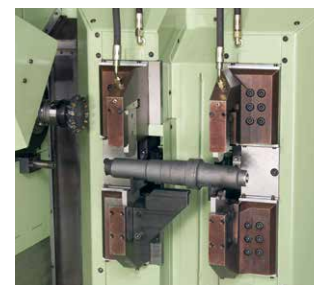
Werkstückspannvorrichtungen, zentrisch arbeitend, wahlweise mit 3-Punkt- oder 4-Punkt-Spannung
