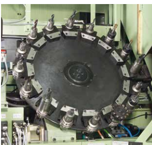
Werkzeugmagazine, ausgelegt als 8-fach, bzw. 16-fach Tellermagazine
